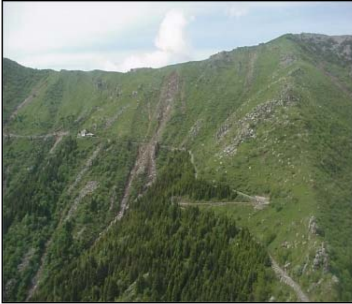
Fig.28. Comune di San Paolo Cervo, presso ristoro Rosazza. Vista aerea delle frane per fluidificazione della coltre detritica che hanno interrotto la strada per la galleria di Rosazza.
