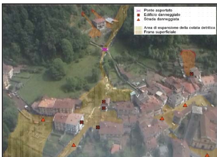
Fig.19. Vista aerea della colata di detrito del rio Piaro che ha provocato danni funzionali agli edifici situati nell'intorno. Il materiale più fine ha imboccato la via Roma invadendo il portico del municipio e continuando la sua discesa verso la chiesa parrocchiale.
