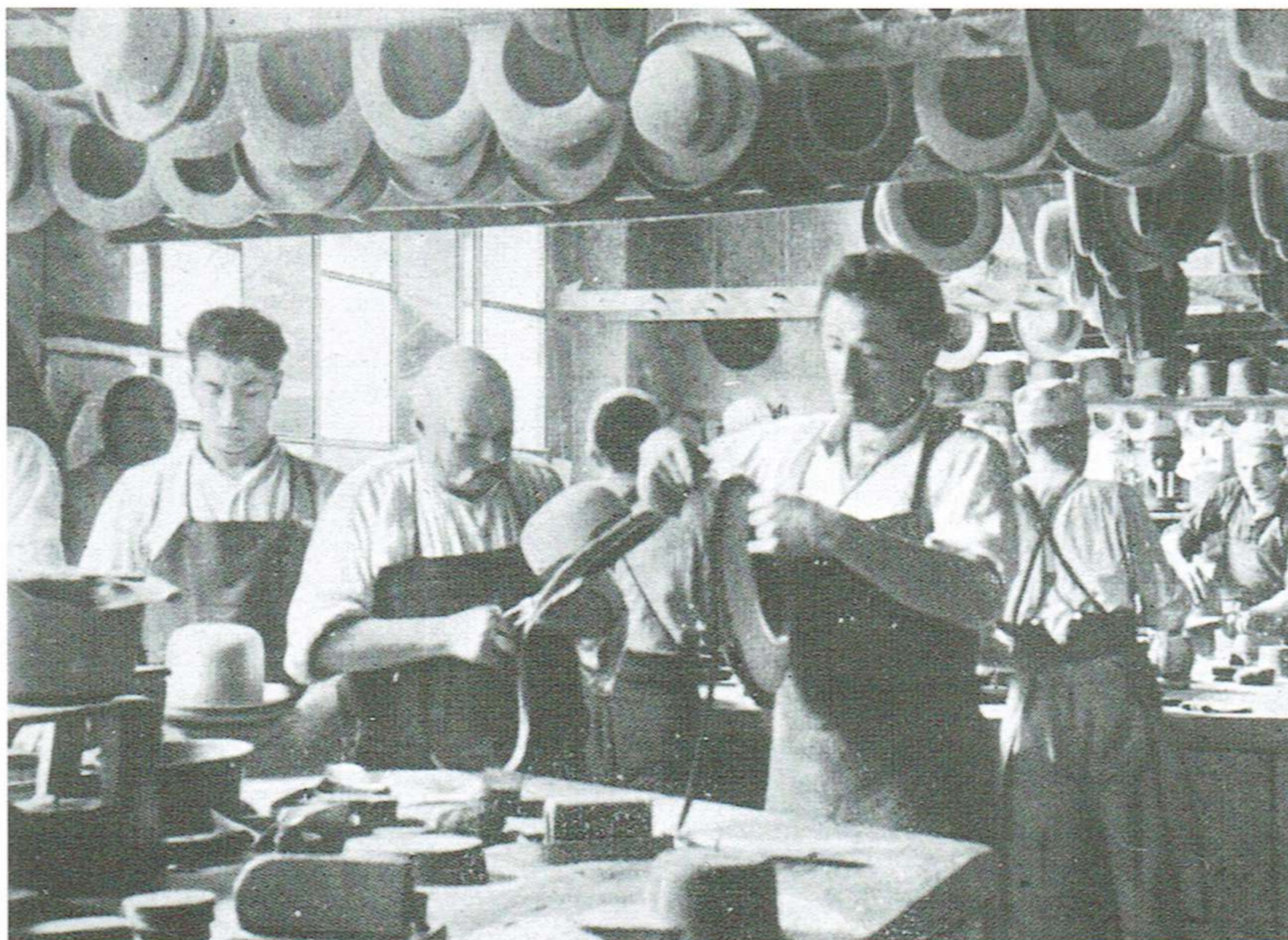
Cappellificio Barbisio, la rifilatura manuale dell'ala, Sagliano. (da «Dove si fabbrica il cappello Barbisio», 1935)
