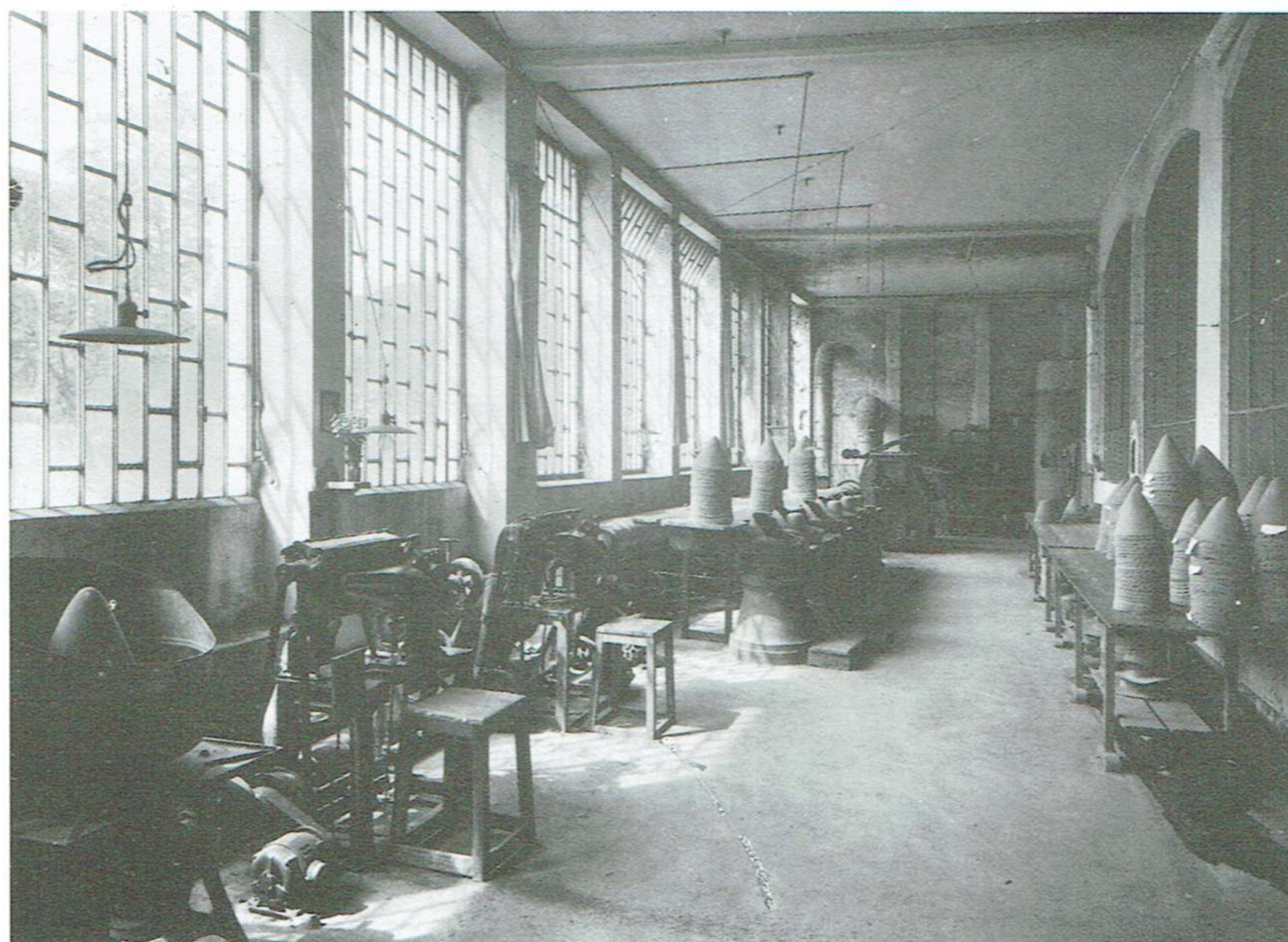
Cappellificio Cervo, in primo piano macchine sbarbatrici, in secondo piano pomiciatrici, Sagliano, 1947. (FSSG, Fondo Rossetti)
