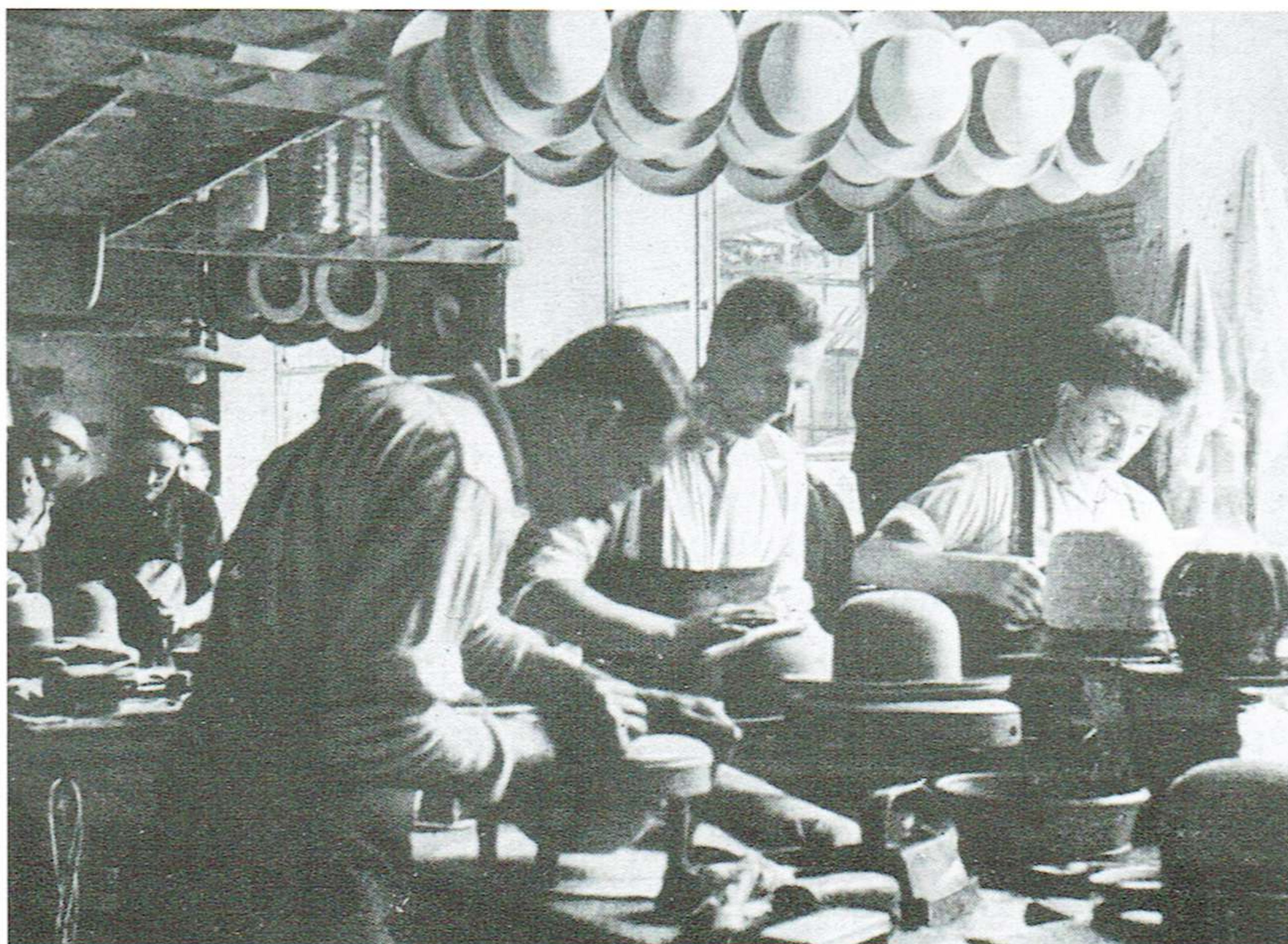
Cappellificio Barbisio, la modellatura manuale del cappello, Sagliano. (da «Dove si fabbrica il cappello Barbisio», 1935)
