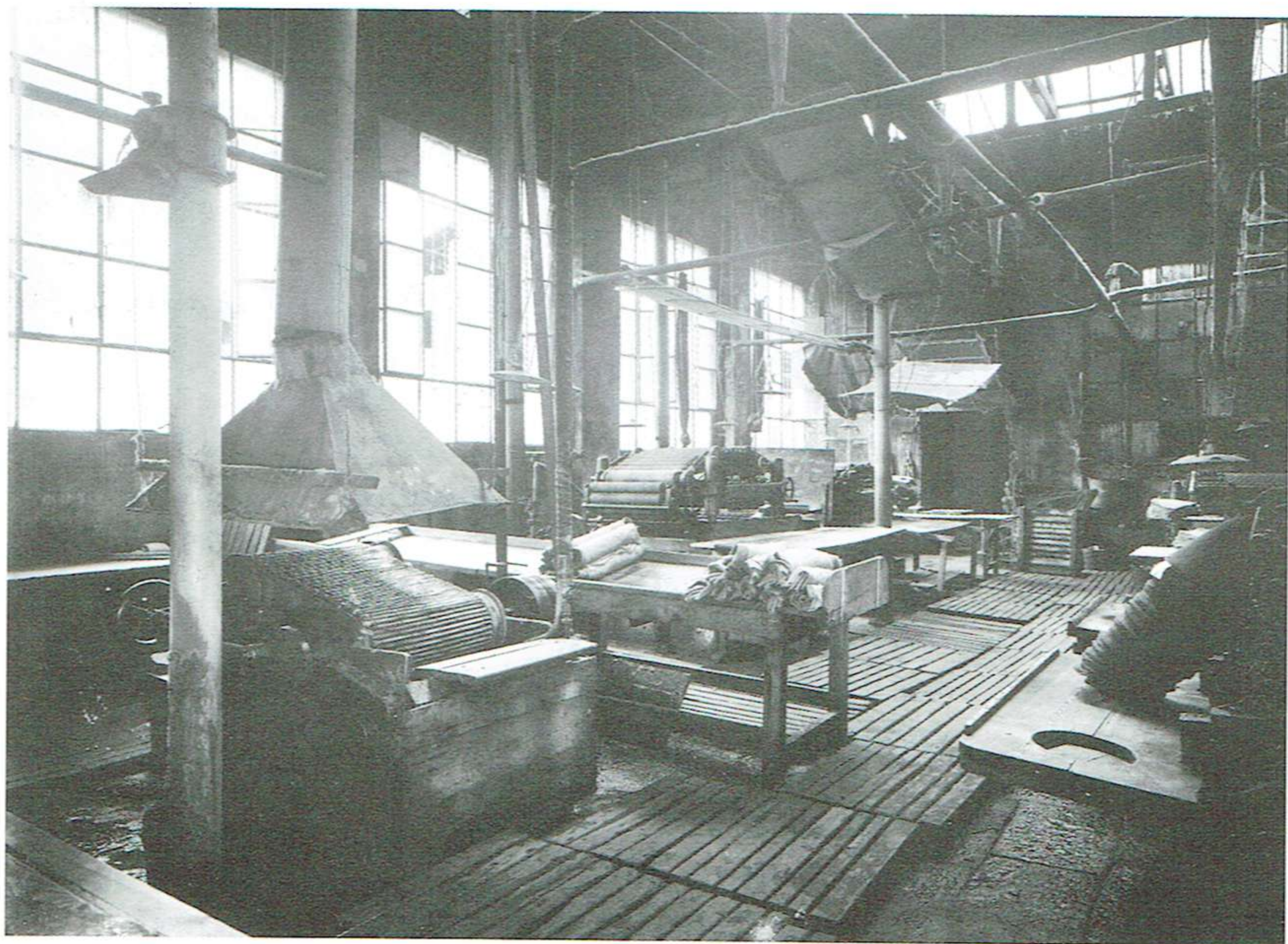
Cappellificio Cervo, in primo piano la macchina slantatrice, dietro la Coq multirulli, Sagliano, 1947. (FSSG, Fondo Rossetti)
