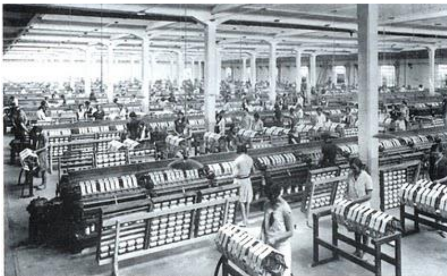
Sala Viscosa. Solo di asportazione per convertire il filato in rocchetti in matasse.
