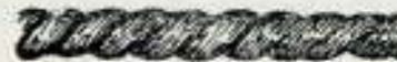
Fig. 2. - Filo già torto, per cui le fibre si dispongono ad elica, tirandolo le eliche si comprimono reciprocamente ed il filo acquista resistenza alla trazione.
