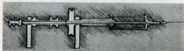
Fig. 13. - Sezione del fuso e dell'aletta disegnata da Leonardo (Codice Atlantico folio 393 verso a).
