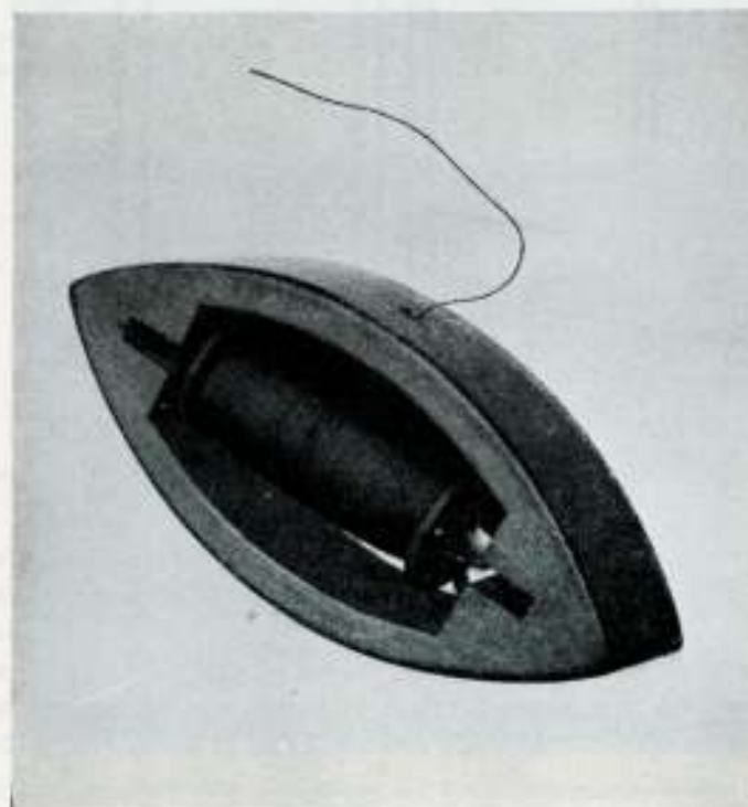
Fig. 33. - Navetta di Leonardo ricostruita secondo l'interpretazione di GIUSEPPE BOMBELLI (da Enciclopedia Storica delle Scienze).
