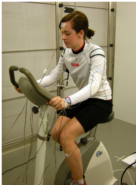
Laboratorio di Alta Tecnologia Tessile (LATT) - Città Studi, aprile 2008. Test in camera climatica su atleti della Nazionale Italiana Vela per la valutazione della t-shirt 'Area 51' prodotta da Slam in vista delle Olimpiadi di Pechino.
