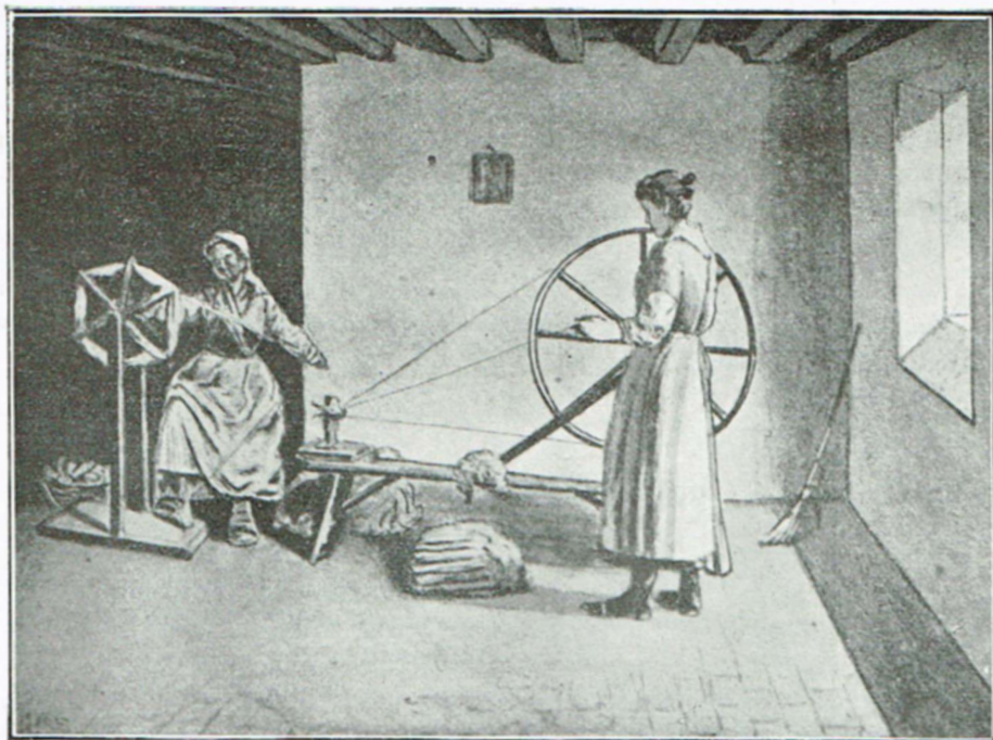
Antico « filarello » ossia « ruet » rappresentante come si filava la lana prima dell'introduzione delle macchine.
